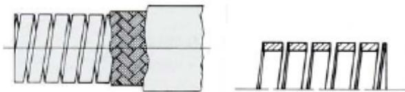
**Metallschlauch mit Ummantelung**
